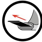
**09** Schutzschläuche zum Ausgleichen des Anschlagmittels beim Hebevorgang scharfkantiger Lasten nutzen!
