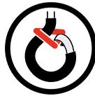
**07** Verwendung von beschichteten Hebebändern im Schnürgang nur mit Beschlagteilen!
