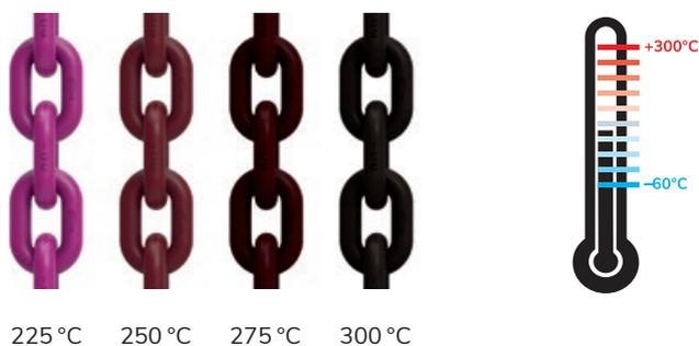
Auch die fluoreszierende Pink-Pulverbeschichtung der VIP-Kette verändert bei extremen Einsatztemperaturen dauerhaft ihre Farbe – in diesem Fall bei über 200 °C. Bei einer unzulässigen Erhitzung über 380 °C ändert sich der Farbton zu Tiefschwarz, und es bilden sich kleine Blasen. Die VIP-Kette muss dann ausgetauscht werden.
